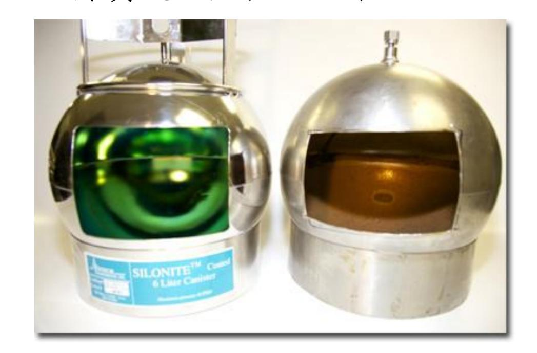
不鏽鋼採樣桶提供比其他空氣採樣工具,如: 採樣袋、吸附管更多的優勢。當採樣桶一開始 推出的時候,"SUMMA"採樣桶是當時唯一的選 項。今日,隨著產品的多元化,市面上有電解 拋光,鍍矽內襯(Silonite® 及其他),玻璃採樣瓶 (Bottle-Vac),以及多種閥和壓力表的選擇,空 氣監測人員必須進一步接受訓練,針對如何正 確的選擇,清潔,評估和認可使用於TO14及 TO15分析的採樣桶。此篇文章提供了不同類型 採樣桶的背景概述,以及相關使用的正確認證 程序。按此連結下載應用資料
